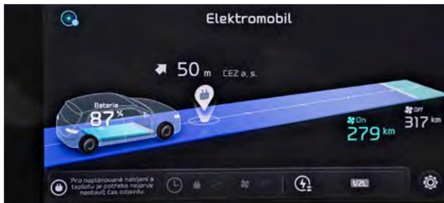
Elektrická Kia EV6 poskytuje řidiči mnoho praktických informací. Je mezi nimi nejen dostupná kapacita akumulátoru, ale rovněž dojezd podle způsobu využívání klimatizace a také nejbližší nabíjecí stanice. Lze zde nastavit rovněž parametry funkce V2L, kdy vůz elektřinou z baterie dokáže napájet externí spotřebiče.
